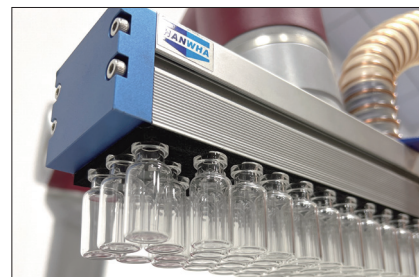
* 海绵吸具HVGP吸取玻璃小管
